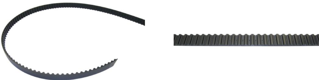
Les courroies crantées ne reposent pas sur le frottement pour faire tourner les poulies comme beaucoup d'autres types de courroies ; le plus souvent, les crans de la courroie sont conçus pour s'intégrer aux dents des pignons. Les courroies ne glisseront pas tant que la tension correcte est maintenue. Les dents agissent généralement perpendiculairement à la direction de la courroie.
