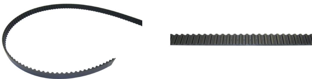
Le cinghie dentate non si basano sulla frizione per ruotare le pulegge, come fanno le altre tipologie di cinghie; più di frequente, i denti sulla cinghia sono **pensati per inserirsi negli spazi negativi** sui pignoni. Le cinghie non scivolano se mantengono la tensione corretta. Normalmente i denti scorrono perpendicolari alla direzione della cinghia.
