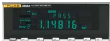
Brug opsætningstasterne (S1-S6) for at få hurtig adgang til gentagne målinger. Opsætningen kan omfatte grænsesammenlignings-funktion med bestået/ikke bestået indikatorer
