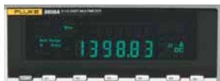
Fluke 8808A har to lavimpedans lavstrømsområder til måling af følsomme lækstrømme
